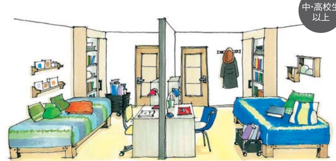
自立に向けて間仕切り壁で個室化。壁は将来、撤去可能につくりしておく。間仕切り収納は分割し、再利用する
