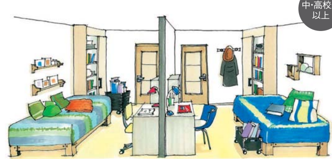
自立に向けて間仕切り壁で個室化。壁は将来、撤去可能なつくりしておく。間仕切り収納は分割し、再利用する
