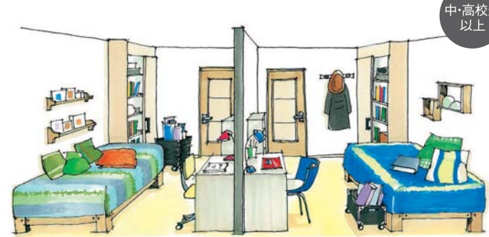
自立に向けて間仕切り壁で個室化。壁は将来、撤去可能につくりしておく。間仕切り収納は分割し、再利用する
